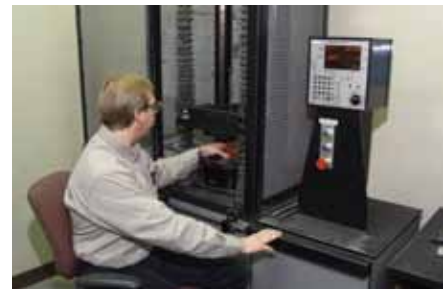
Pruebas de resortes controladas por computadoras - Con ayuda de software personalizado, los probadores de resortes dan seguimiento y verifican la uniformidad de las dimensiones y del factor de compresión de los resortes.
